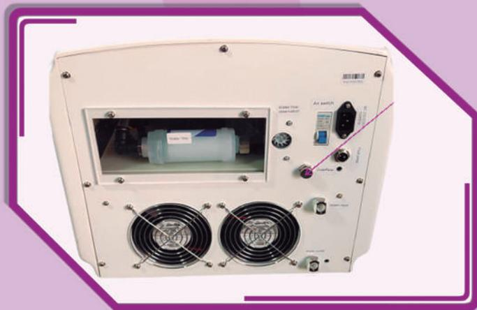
2. Abra la tapa del orificio de rebosamiento (Overflow) e inserte el embudo en la válvula (water input). Llene con agua destilada desmineralizada hasta que desborde por el orificio de desbordamiento.
