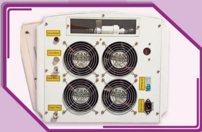
2. Abra la tapa del orificio de rebosamiento (Overflow) e inserte el embudo en la válvula (water input). Llene con agua destilada hasta que desborde por el orificio de desbordamiento.
